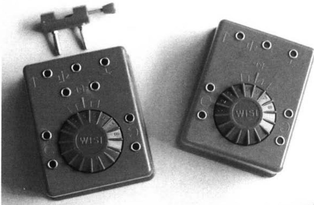
Bild 5: Typ 58 (links), der "Alte" in neuen Gehäuse; Typ 58 D (rechts), der Diodenempfänger als letztes Modell.
