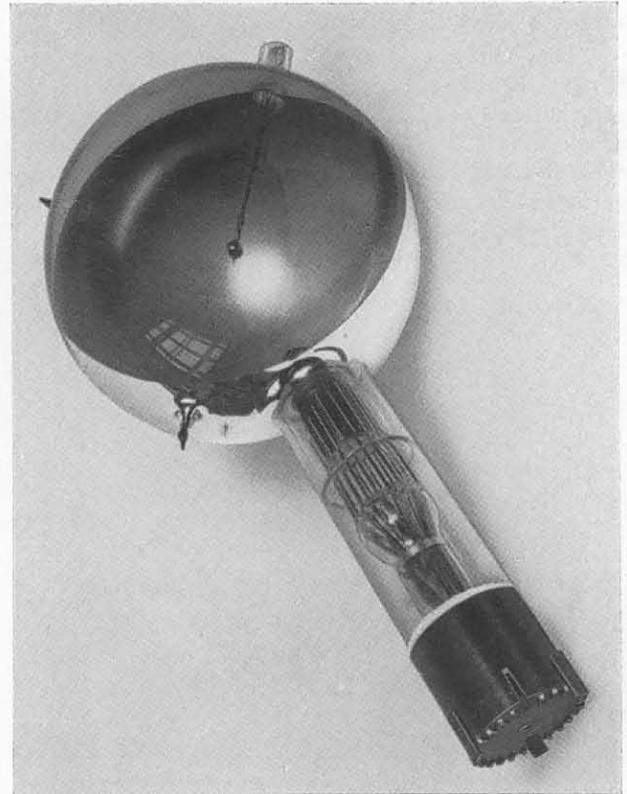
Abb. 1a: Photozelle mit Sekundärelektronenverstärker für Gegensehanlagen 1938.
