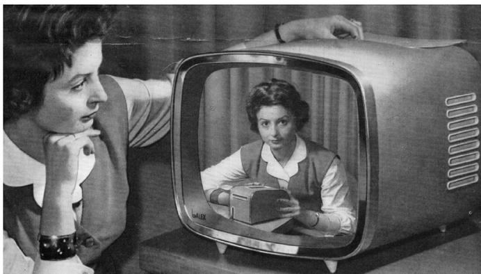
Schwarz-Weiß-Fernsehgerät „Alex“ (VEB Stern-Radio Berlin 1958) Sehr kompakte Form, aus dem Wesentlichen konzentriert. Alle Bauelemente wurden auf engstem Raum um die Bildröhre montiert. So ist diese funktionale Form möglich, bei der die Bildröhre als einziges technisches Detail betont wird. Ausgezeichnet mit dem Designpreis „Gute Form“.
