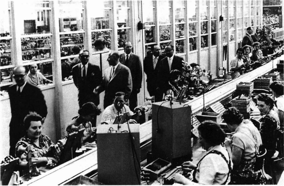
Bild 3: Blick in die Spulenwickerei (ca. 1953). Man ahnt, wieviel Handarbeit bei der Herstellung von Rundfunkgeräten erforderlich war.
