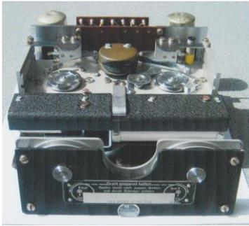
D6 Gerät mit Sprechkopf
