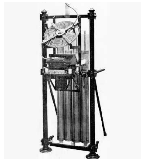
Bild 8: Spiralförmige Senderspule mit „Stoßkreiskurbel“ der 2,5-kW-Landstation Type 2,5 TK, Fa. Telefunken 1912 [7], dahinter die Leidener Flaschen
