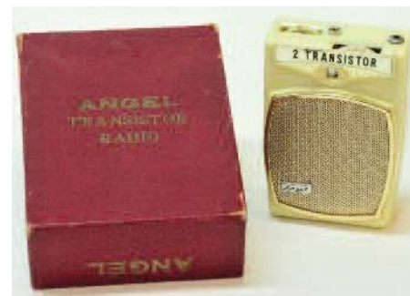
Bild 6: Angel TR-25, ein typisches Boy's Radio mit 2 Transistoren und Anschlüssen für Ohrhörer und Wurfantenne, hergestellt in Japan für Arrow Trading New York, um 1959
