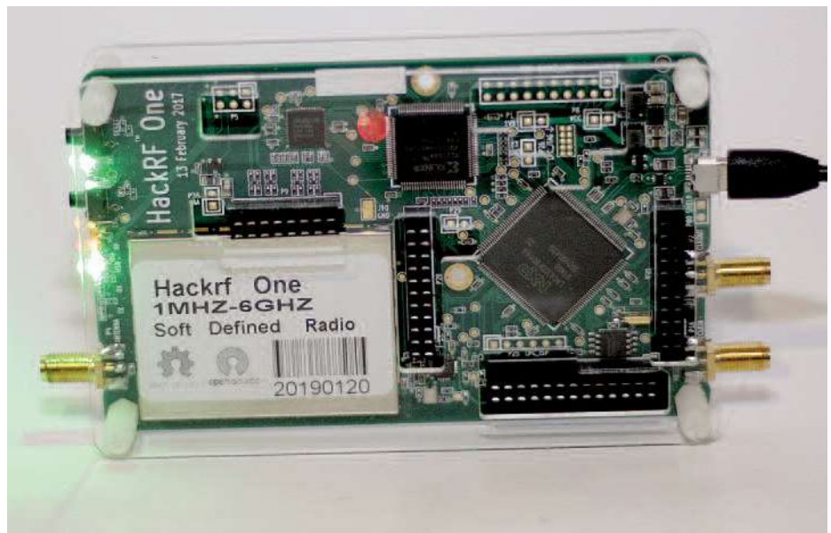
Bild 3: SDR-Modul HackRF one
