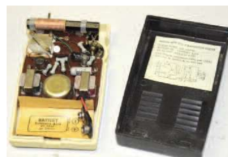
Bild 8: Überschaubares Innenleben eines Boy's Radios: Zwei Transistoren, Zwei Übertrager
