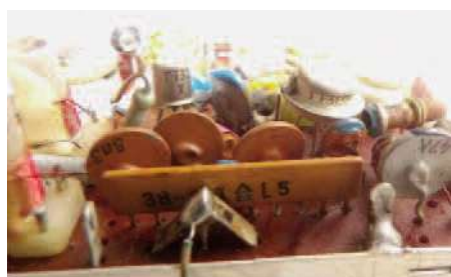
Bild 2: Widerstandsnetzwerk im UKW-Tuner mit Germaniumtransistoren; deutlich zu erkennen: das Logo der Keramischen Werke
