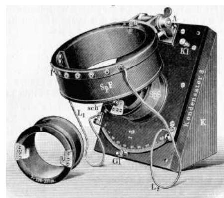
Bild 10: Empfangsspulenkoppler mit Antennenspule SpP (Primär) und Fritterkreisspule SpS (Sekundär), im Gehäuse Drehkondensator betätigt durch Gleitknopf Gl, Fa. Telefunken 1907 [5], daneben Spule für anderen Wellenbereich
