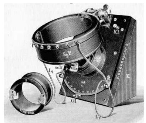
Bild 10: Empfangsspulenkoppler mit Antennenspule SpP (Primär) und Fritterkreisspule SpS (Sekundär), im Gehäuse Drehkondensator betätigt durch Gleitknopf Gl, Fa. Telefunken 1907 [5], daneben Spule für anderen Wellenbereich
