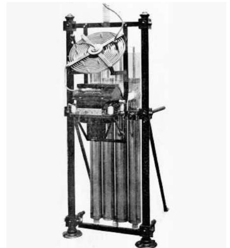
Bild 8: Spiralförmige Senderspule mit „Stoßkreiskurbel“ der 2,5-kW-Landstation Type 2,5 TK, Fa. Telefunken 1912 [7], dahinter die Leidener Flaschen
