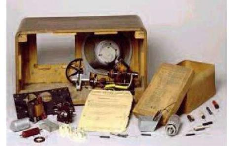
Bild 2: Komplettansicht eines RVF Baukastens „Heinzelmann“ W (V2)
