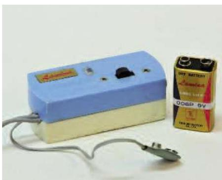
Bild 4: 9-Volt-Batterie Typ 006P zum Wiederaufladen
