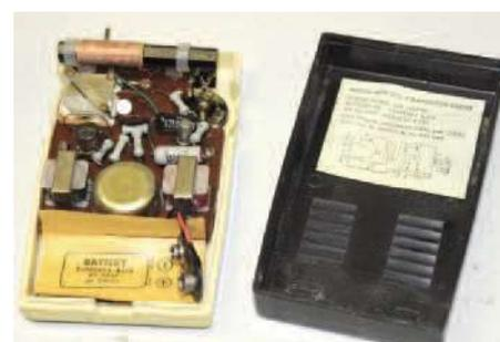
Bild 8: Überschaubares Innenleben eines Boy's Radios: Zwei Transistoren, Zwei Übertrager
