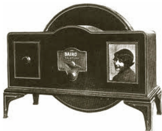
Baird «Televisor» (1926), der weltweite Fernsehempfänger, Bildgrösse 4 x 5 cm, 30 Zeilen.
