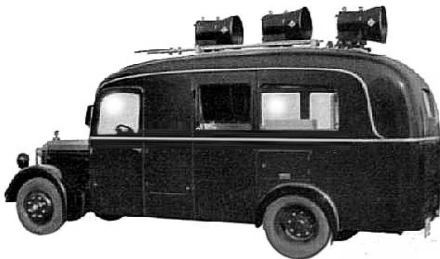
Telefunken-Lautsprecherwagen für Grossveranstaltungen Sprechleistung 160 Watt (1938)
