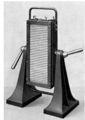
Schmalen Blatthaller (1931), kleinere Variante des quadratischen Blatthallers, ~20 cm breit und 54cm hoch, Felderregung ~200 Watt, Belastbarkeit rund 100 Watt.
