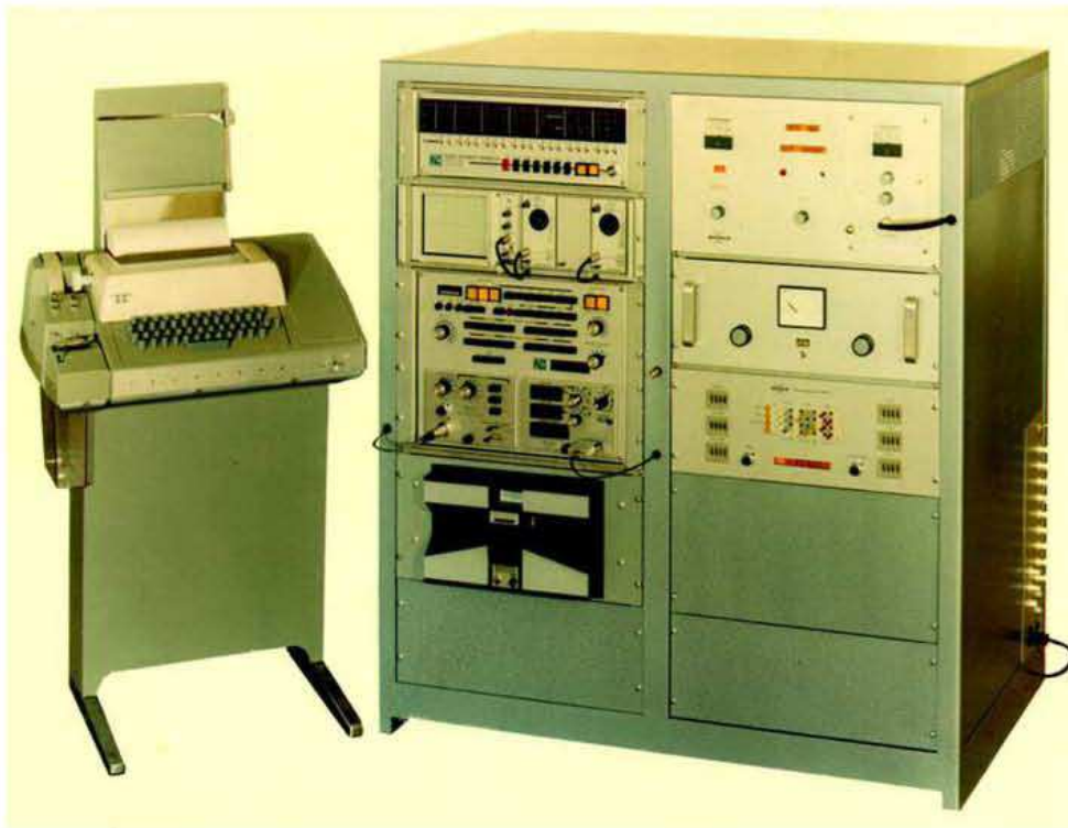
Zusatzausrüstung zum HFX 90 Spektrometer aus dem Jahre 1970, bestehend aus Nicolet Rechner, D Lock, manuellem Puls Generator und «schnellem Leser»
