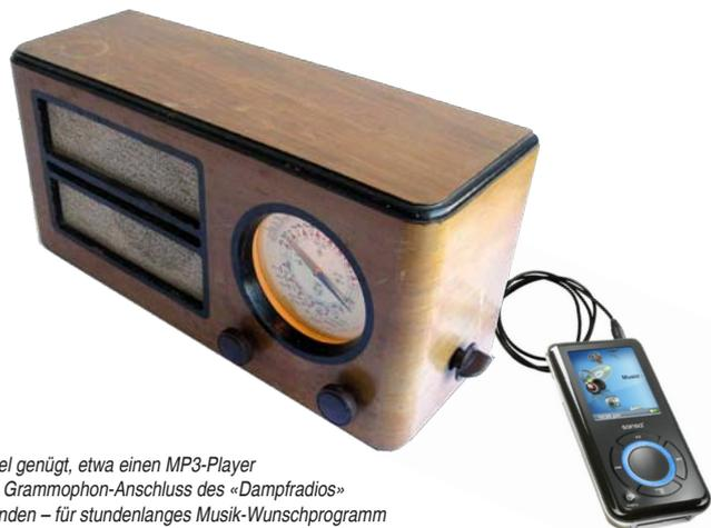
Ein Kabel genügt, etwa einen MP3-Player mit dem Grammophon-Anschluss des «Dampfradios» zu verbinden – für stundenlanges Musik-Wunschprogramm
