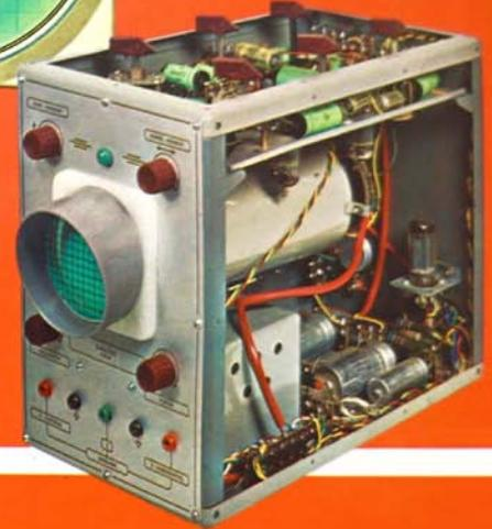
Eingebaute Eichspannungsquelle zum Messen der an die Y-Achse angelegten Spannungen von Spitze zu Spitze.
