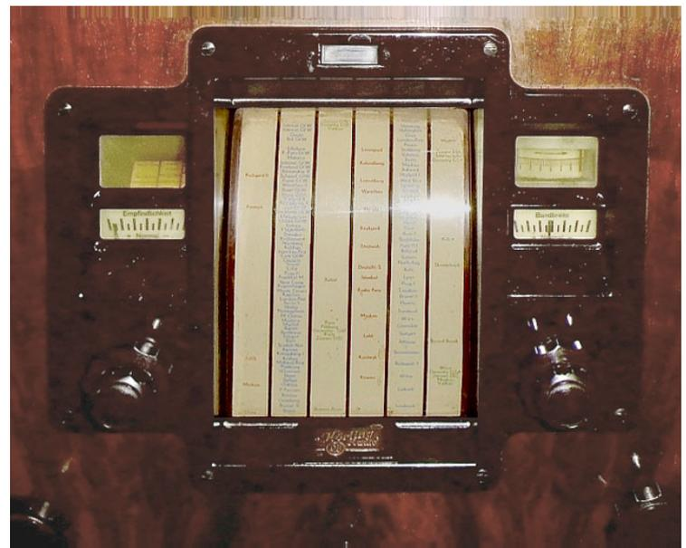
Die «Alloptik»-Front: Eine «Lupenskala» links oben, darunter die Skala für die Empfindlichkeits-Voreinstellung\*, in der Mitte die Sendernamen-Flutlichtskala mit «Lichtzeigern», rechts oben die Feldstärken-Anzeige, darunter die Skala für die Voreinstellung der Bandbreite\*.
