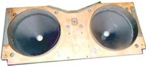
Ein Blick ins Gehäuse und unters Chassis zeigte: Alles noch komplett und unverbastelt – eine hervorragende Grundlage. Die beiden Lautsprecher, im Prohaska-Katalog als «verschiedenfarbig abgestimmt» bezeichnet, sind nicht gleich, sie haben verschiedene Feldspulen, aber auch verschiedene Frequenzcharakteristik.
