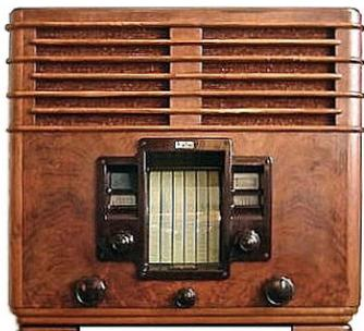
Nur wenige Geräte der Vorkriegszeit sind – nach alten Werbetexten beurteilt – derart aufwendig konstruiert worden wie der Körting **Ultramar**, ein Gross-Super, genauer: Ein Vorstufensuper, mit vielen Extras. Ein aufgrund des damals sehr hohen Preises extrem seltener Apparat. Der Hersteller baute alles ein, was damals möglich war, die Werbeversprechen überschlugen sich – so im Prospekt der Berliner Firma Prohaska:
