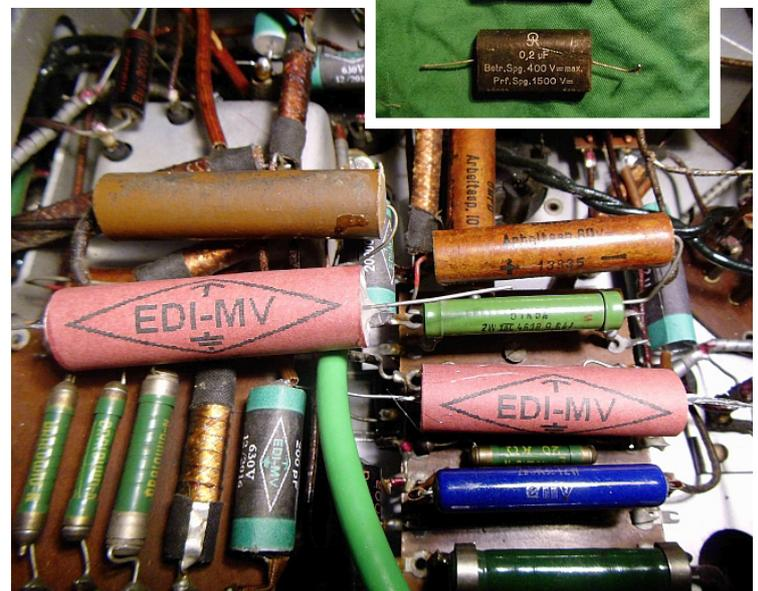
Die «Edi-Kondis» haben nur eine einfache Hülle, die ihre Stabilität durch den innen liegenden Kondensator, die aufgeklebte Etikette (beides aus gewöhnlichem Druckerpapier) und die an beiden Enden aufgetragene Heissklebmasse erreicht.
