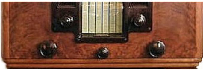
Fünf Bedienknöpfe sind zu sehen: Ein-/Ausschalter/Lautstärke (links unten), schräg rechts darüber ein Doppelknopf für Empfindlichkeits- und Bandbreiten-Voreinstellung, in der Mitte der «Optikator» für «lautlose» Sendereinstellung, dann ein Doppelknopf für Grob-/Fein-Skalenantrieb, und ganz rechts der Umschalter für Kurz-, Mittel-, Langwelle und Tonabnehmer («TA»).
