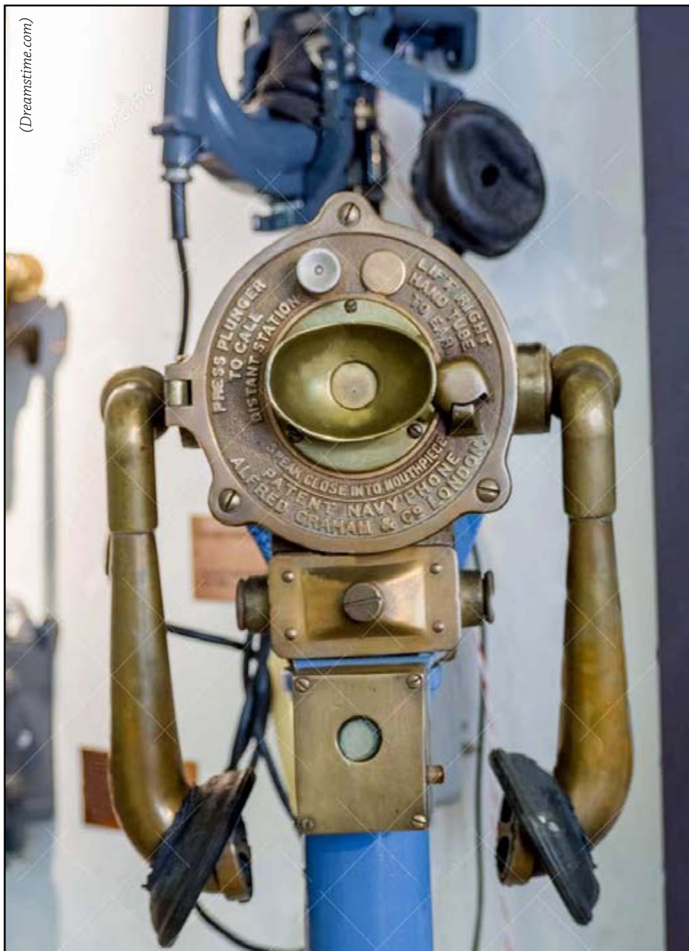
Graham «Navyphone», Telefon für die Kommandobrücke: laut, vibrations-, korrosions- und schuss- fest... Robustes Gehäuse aus Stahl- und Bronzeguss, so angelegt, dass die sich im Inneren befindenden Magnete den Schiffskompass nicht beeinflussen konnten.
