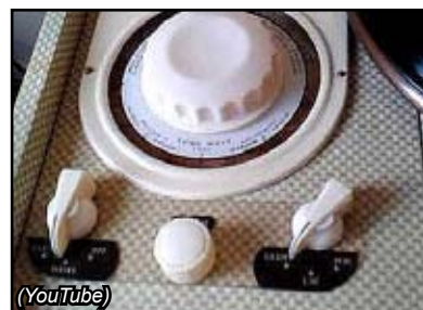
Alba 707, 1952 Radio-/Grammokoffer für Batterie- und Netzbetrieb (Plattenspieler mit Federwerkmotor). Empfängt Mittel- und Langwellen. Plattenspieler 78 rpm mit «Fast-Slow»-Regler.
