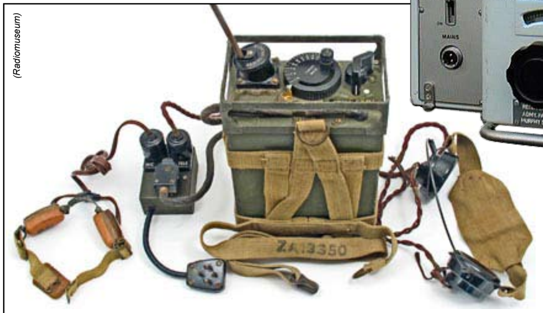
Murphy «Wireless Set No. 38 Mk II» 10 Kilo schweres Armee-Funkgerät für die Infanterie, 1941
