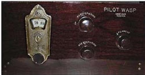
Es ging ihm vor allem auch darum, die Bereichs-Umschaltung zu revolutionieren, das damals überall noch gebräuchliche Auswechseln von Steckspulen durch einen einfach zu bedienenden Nockenschalter zu ersetzen.
