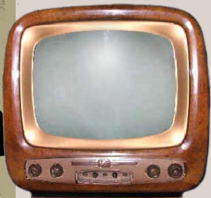
Fernsehgerät Geloso GTV1014 mit 21 Röhren (1956)
