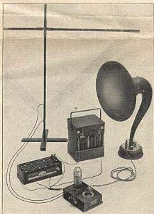
vor allem mittels Lautsprecher, sind bei dem Loewe-Ortsempfänger durch eine völlig neue und einzigartige Ausgestaltung des Prinzips der Widerstand-Kondensatorverstärkung gelöst worden, insofern, als im Inneren der Röhre ein System geschaffen wurde, das den gesamten Verstärkungsvorgang von der geringen einfallenden Energie bis zu der hohen Lautsprecherleistung
